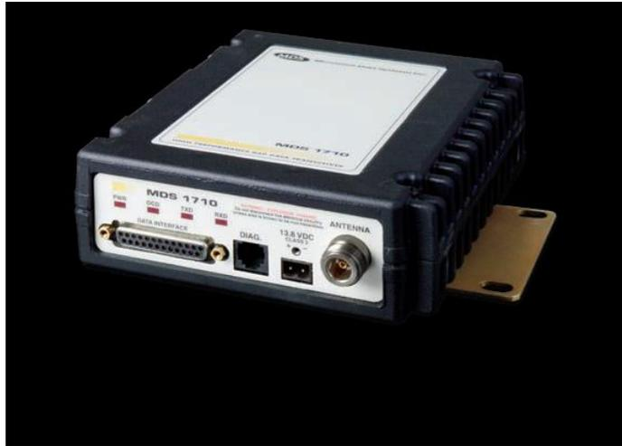
美国 GE MDS 公司遥测、遥控系列数字电台采用数字信号处理、纠错编码、软件无线电、数字调制解调和表面贴片一体化设计等技术，具有高性能、高可靠的特点，电台提供标准 RS-232 数据接口可直接与计算机、地震数据采集器、RTU、PLC、数据终端、GPS 接收机。传输速率 19200bps，误码率低于  $10^{-6}$ (-110dBm 时)，发射功率 0.5~5 瓦可调节，任何型号的电台可设置为主站或远端站使用，通信距离达 70 公里，能适应室内或室外的恶劣工作环境。电台数据和语音兼容，可工作于单工、半双工、全双工（双电台）方式，收发同频或异频组网，并具有远程诊断、测试、监控功能，满足各种应用的遥测中心与众多远方站之间的远距离、高速、高可靠的数据采集和控制。
